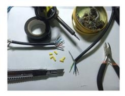
Зачищаем ножом и кусачками края провода от изолирующего слоя
